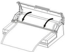
Legen Sie ein Ende des Beutels über den Schweißbalken aber nicht in die Vakuumkammer.
