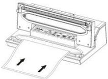
Vergewissern Sie sich, dass sich beide Seiten des offenen Endes des Beutels innerhalb der Vakuumkammer befinden. Dies garantiert, dass kein Vakuum entweicht.
